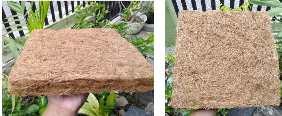
Gambar 1. Produk Peredam Suara dari Sabut Kelapa
