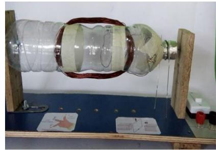
**Gambar 6.** Media untuk menunjukkan prinsip kerja motor listrik
