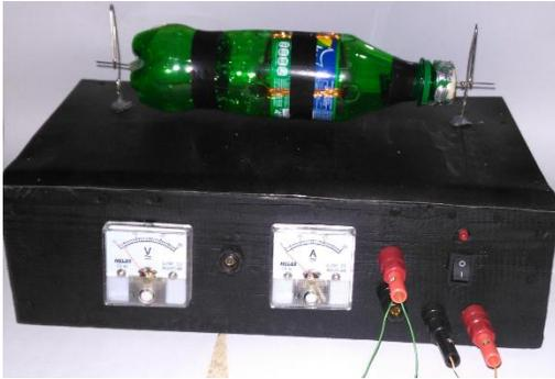
**Gambar 7.** Media kudamatrik untuk mengukur tegangan dan arus pada kumparan
