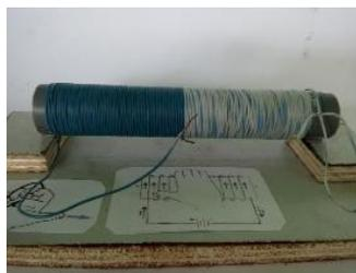
**Gambar 1.** Kudamatrik 1 untuk menunjukkan adanya kutub magnet pada kumparan
